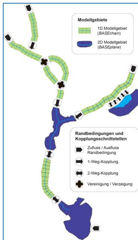
Bild 5. Möglichkeiten zur Kopplung des 1D- und 2D-Modells von BASEMENT.
