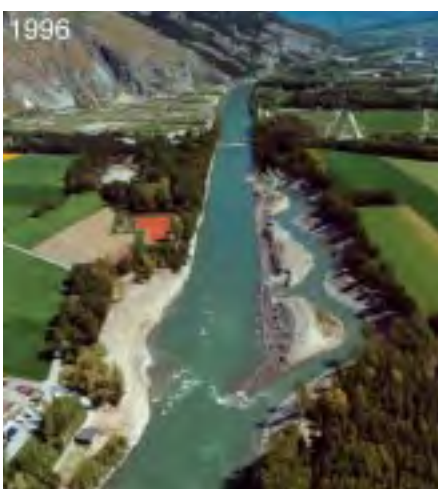
Bild 13. Aufweitung Felsberg am Alpenrhein kurz nach dem Bau und fünf Jahre später. Das Gerinne soll sich durch Seitenerosion selbständig verbreitern können (Foto: Tiefbauamt des Kantons Graubünden).
