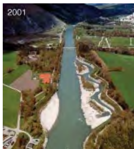
Bild 13. Aufweitung Felsberg am Alpenrhein kurz nach dem Bau und fünf Jahre später. Das Gerinne soll sich durch Seitenerosion selbständig verbreitern können (Foto: Tiefbauamt des Kantons Graubünden).
