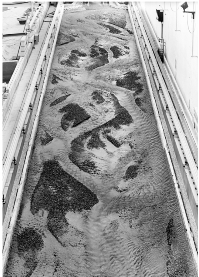
Abb. 2: Übersicht der Laborrinne während eines Versuches mit stark verzweigter Morphologie.
